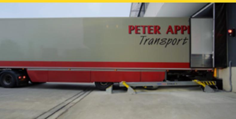
Anhänger mit Seitenverkleidung und geringer Bodenfreiheit.
