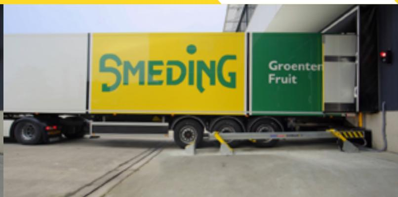
Anhänger mit mehreren Achsen und Hinterlenkachsen.
