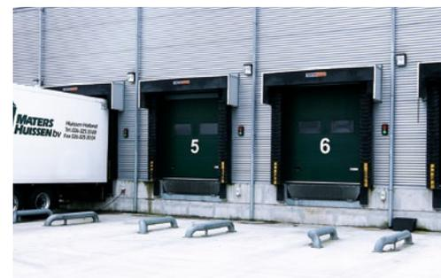
Durch die nahezu hermetische Abdichtung ist die WI-Serie besonders geeignet für die Beherrschung kritischer Klimazonen wie z.B. die Verladestellen bei Kühl- und Gefrierhallen. Das System ist universell anwendbar sowohl bei bestehenden als auch bei neuen Gebäuden und wird für alle Lkw-Größen angepasst gebaut. Hochwertiges Material – wie z.B. Kissen aus Cordura und Rahmen aus Isopanelen – tragen zu einer optisch ansprechenden Ansicht und einer langen Lebensdauer bei.
